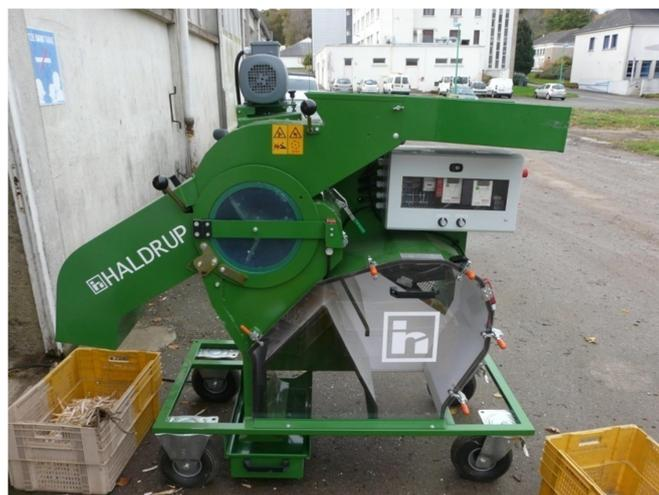
Figure 6: Batteuse à bottillons (battage de haricots)
